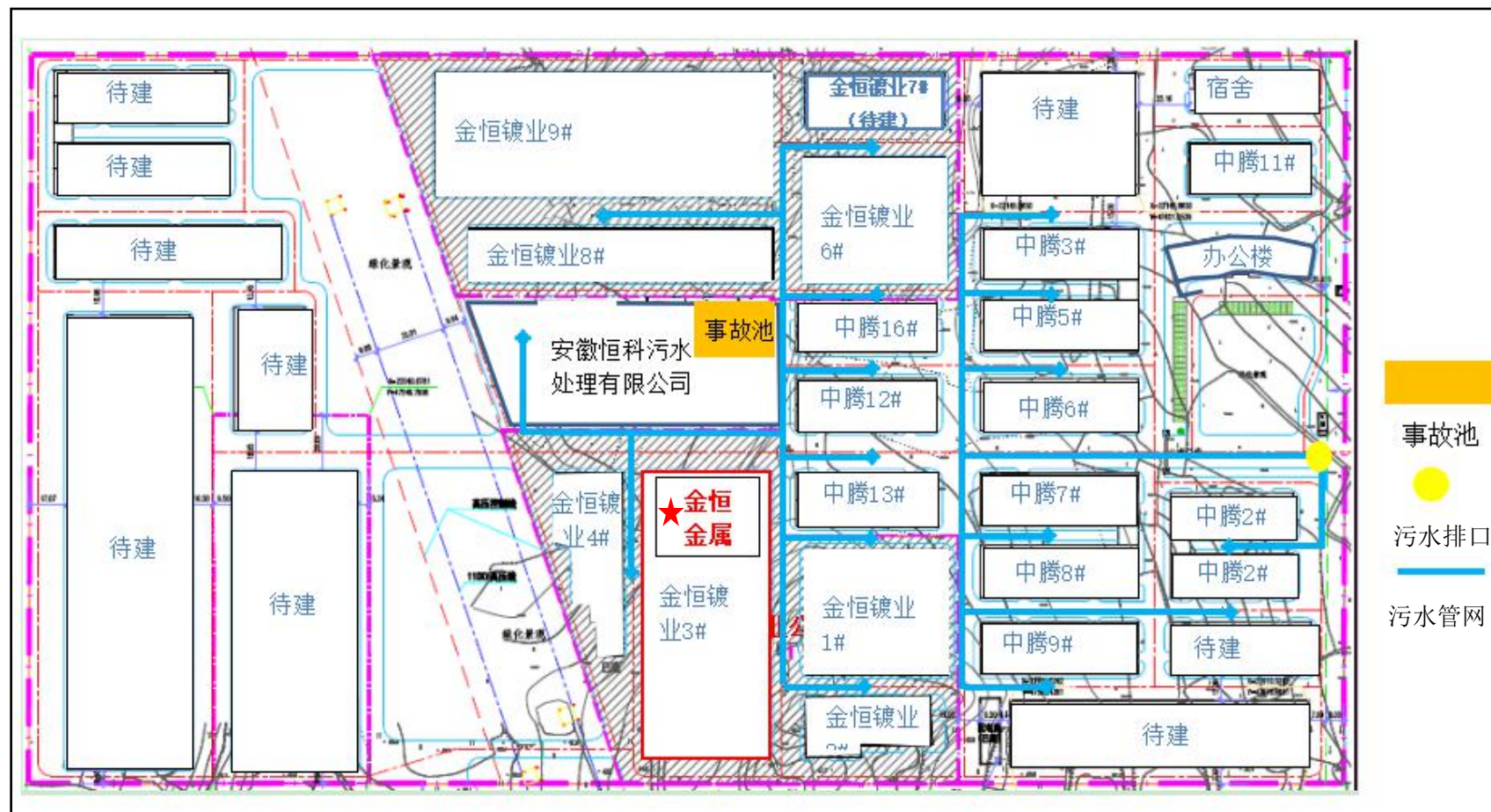
图4-1 电镀中心污水收集管网图
